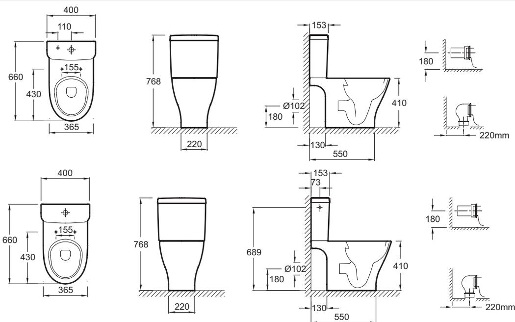
Спецификация продукта: Унитаз «vario». 4957СК. Коллекция: ODEON UP. РАЗМЕРЫ (СМ): 66 x 36,50 см. ВЕС: 23,5 кг. ТИП УСТАНОВКИ: Напольные. РАСХОД ВОДЫ: Экономия воды: 2,6/4 л. ВЫСОТА: Комфорт. ОБОД: Комфортная высота. ПРОДУКТ В КОМПЛЕКТЕ: (бачок и крышка-сиденье заказываются отдельно). КРЫШКА-СИДЕНЬЕ: Не входит в комплект. ГАРАНТИЯ НА КЕРАМИКУ: 25 лет. УПАКОВКА: Единая упаковка.
